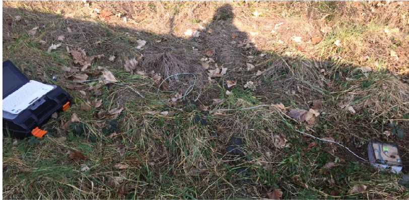
Stazione di misura HVSR
